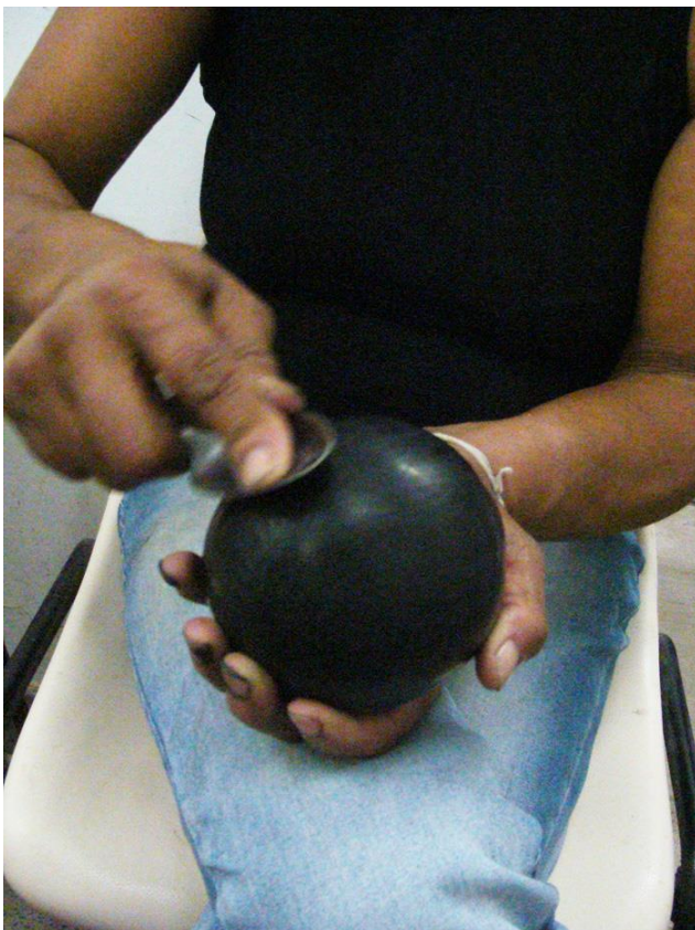
Figura 3 – Fotografia de momento que artesã realiza o lustre na peça de argila esfregando por horas o dorso de uma colher, antes de sua queima que ocorre sem a aplicação de verniz mantendo a rusticidade enquanto elemento distintivo da produção do projeto Caminhos de Barro. A autoria: Lilian Sagio Cezar.
