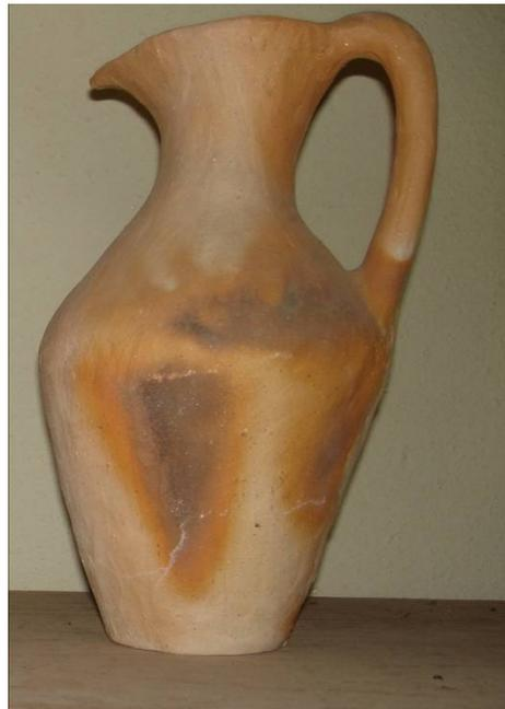
Foto 8: Peça estourada no forno      Foto 9: Peça com rachaduras
